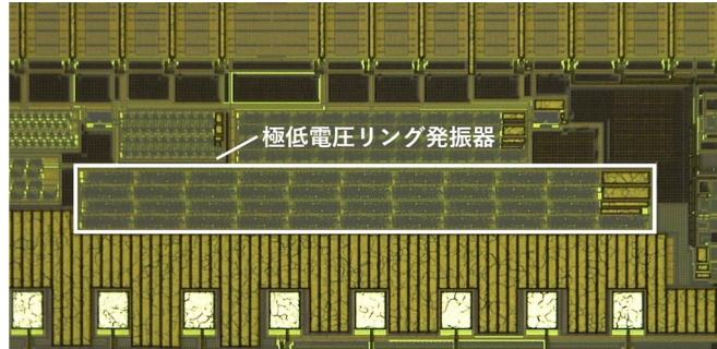
図 4: 極低電圧リング発振器。30 mV の極低電圧での動作を実証しました。
