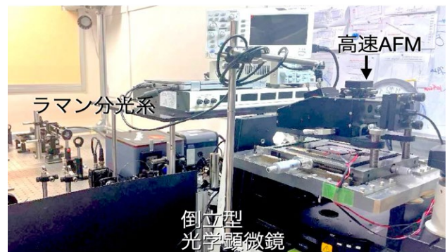
図 2: 実際に開発した高速 AFM/ラマンマルチモーダル計測装置
