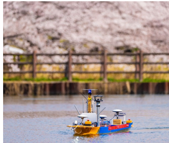
図2 模型を用いた自走試験の様子
