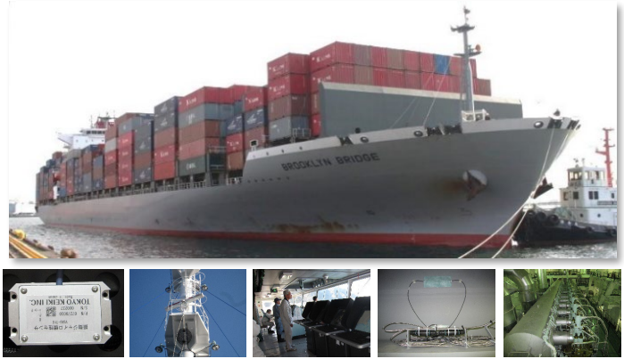
超小型ジャイロ 波浪レーダ VDRシステム FBG歪センサ 主機モニタ
