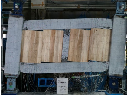
図5 試験体4CLT-60 最終破壊状況
