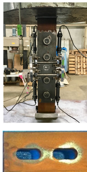
図2 すべり試験体例
