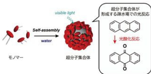
図3. DiI-C18超分子光触媒の疎水場におけるアントラセンの光酸化反応
