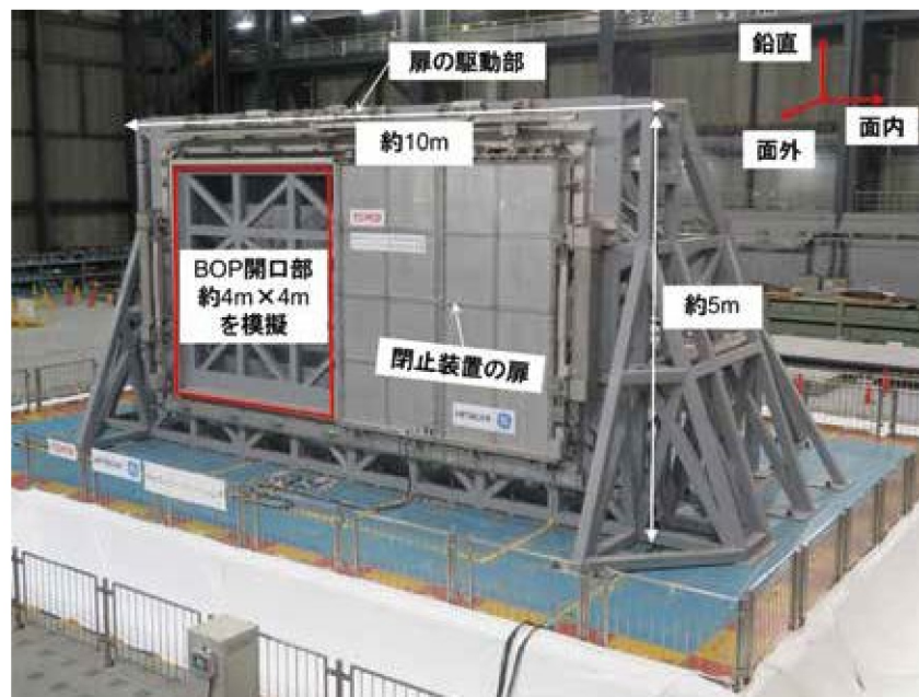
図2 スライド型BOP閉止装置概要
