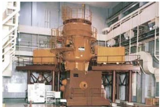
図4 世界最大の電子ビーム溶接機（1980年撮影）
