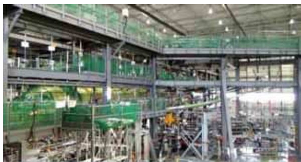
図1 全機静強度試験
