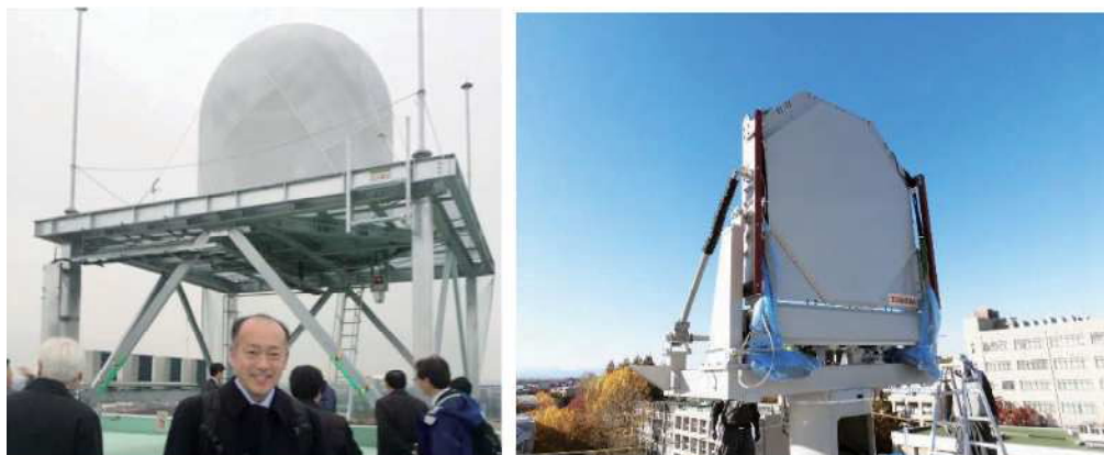
図3 2重偏波フェーズドアレイ気象レーダの外観写真
