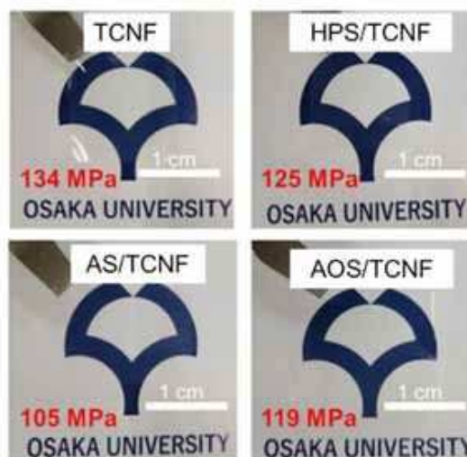
図2. デンプン/TCNF複合シートの優れた機械的強度と高い透明性.
