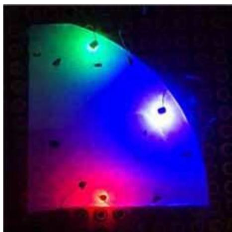
図6 窒化物半導体青色／緑色／赤色LEDの同一サファイア基板上での集積化
