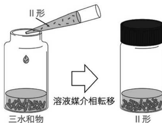
図1 溶液媒介相転移によるII形結晶成長のセットアップ模式図
