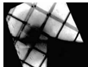
写真3. 液体ナトリウムに浸漬したステンレス金網の透視画像
