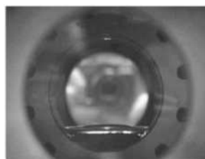
写真2. 液体ナトリウム充填の様子と試作開発した観測窓
