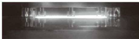
図2 大気圧 VHF プラズマの様子（電極幅：80 mm、電極間ギャップ：0.5 mm）
