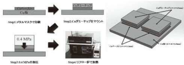
図1 接合サンプルの作製手順および模式図
