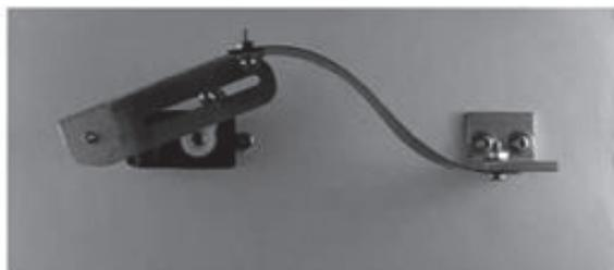
図 5 飛び移り座屈現象
