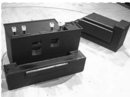
図3 チムニー選定のための風洞実験模型
