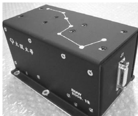
図 4 VHF 波帯広帯域波形測定装置 (雷センサ、実物)
