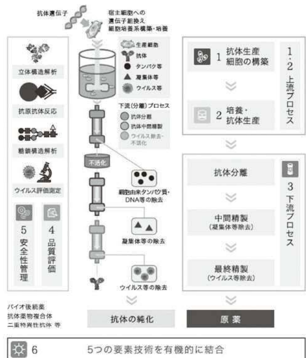
図5 国際基準に適合した次世代抗体医薬等の製造技術研究開発概要 10)
