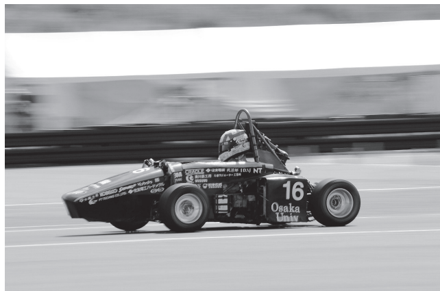
図3：エンデュランスでの OFRAC 車両。 前後ウィングを取り外して耐久走行に臨んだ。
