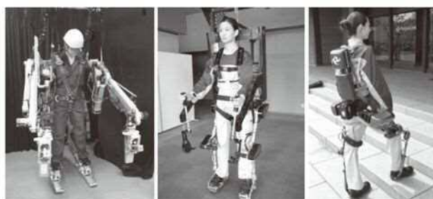
図4 様々なパワーアシストスーツ (左: MS-02, 中: PLL-01, 右: PLN-01 ニンジャ)
