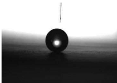
写真5 「TOYAL LOTUS ® 」の超撥水性 (水滴接触角170°以上)
