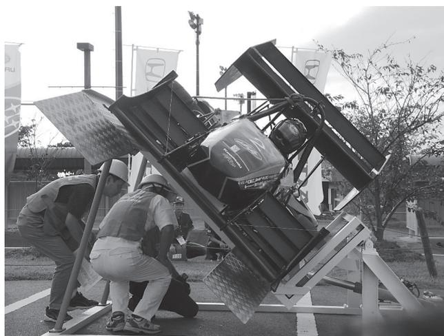
図3：車検でのチルト検査の様子
