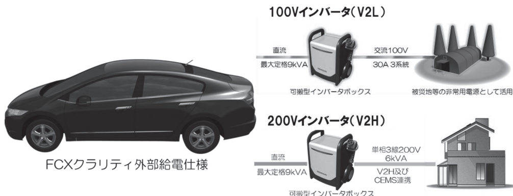
図2 FCX クラリティ外部給電仕様 (9kW)
