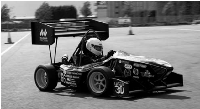
図3 FSAE オーストラリア大会で優勝したモナシュ大学の車両 巨大な空力デバイスが特徴的
