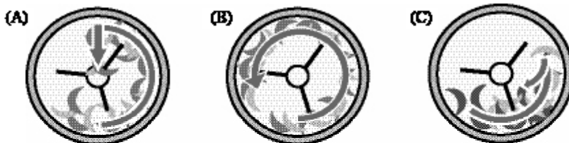
FIG. 3 各胴回転数による茶葉の胴内での様子。(A) 適度な胴回転のとき、葉は胴の頂点に上がって垂直に落ちる。(B) 胴回転が速すぎる場合、遠心力で茶葉が胴の壁部に移動し、胴中央が空洞となる。(C) 胴回転が遅すぎる場合、葉が胴の下部に集まり、胴中央の攪拌軸に攪拌されない。
