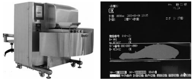
写真3 シャケ切り身機械の外観(左)と画像処理画面の例
